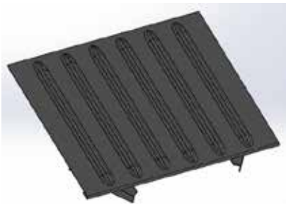
Рис. 3. Кришка люка з двох листів по 3 мм (просторова модель)
